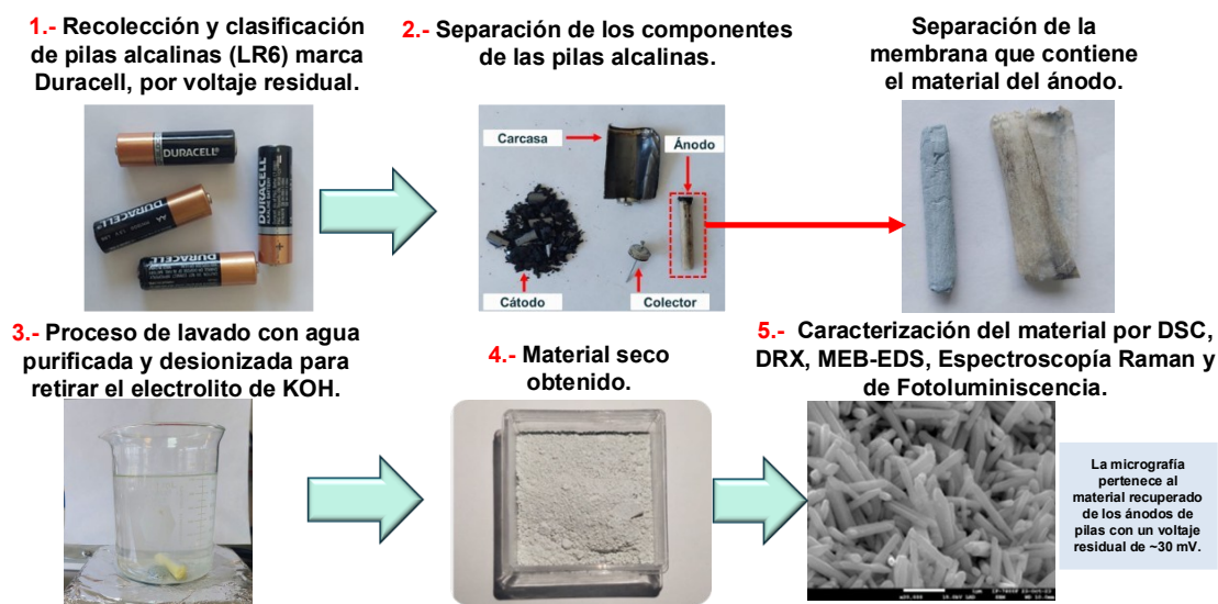
Figura 20. Proceso general de recuperación y lavado de partículas de Zn/ZnO de pilas alcalinas tipo LR6.
